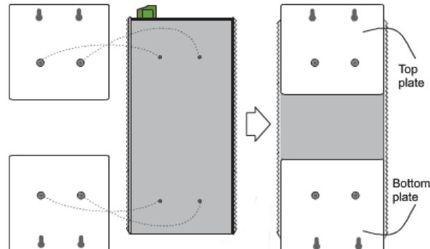
步骤 2：将交换机安装在墙面上，壁挂安装共需要 4 颗螺丝。
